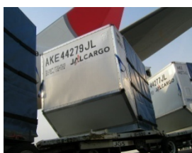
搭載物軽量化 軽量コンテナ導入
